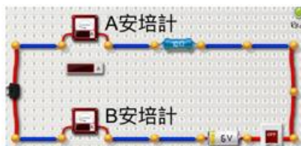
圖4. 使用安培計測量相同迴路的電流
