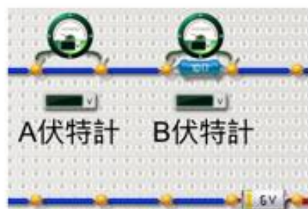
圖3. 使用伏特計測量導線和電阻的電壓
